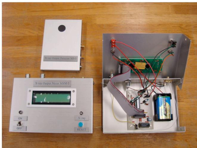
図5 検出部と計測・表示部の外観
