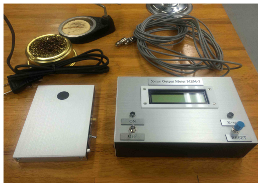
完成した簡易形線量計
