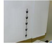
Figure 3 nanoDot線量計を2次側スリットに配置
