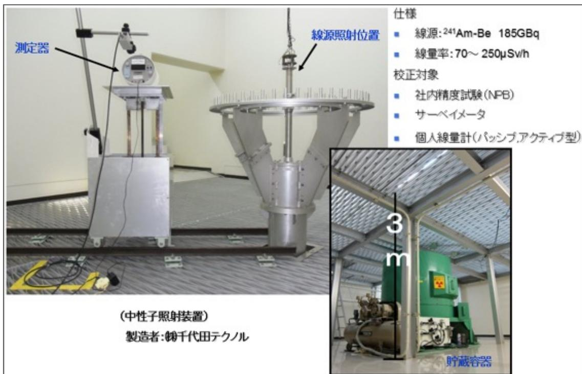
中性子は他の放射線と比べると散乱線が発生しやすいため、これを減らすための設計が施されている。線源の照射位置は照射室の中央に位置するようにし、天井、床、側壁からの散乱線を極力最小限にしている、また、装置等に使用する材質を出来る限りアルミ素材（散乱線の発生が少ない）を使用し、床をアルミのグレーチング（網目構造）にするなど対策をとっている。
