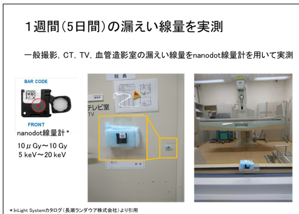
Fig.3 積算形線量計による 1 週間の漏えい線量測定
