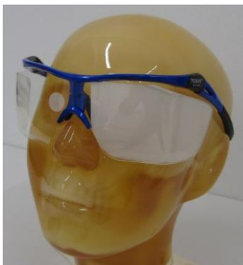
図4 防護メガネ内の線量分布測定
