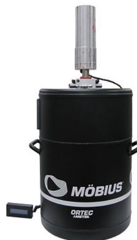
図5 ハイブリッド型冷却器
