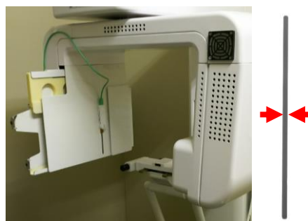
図 2. 二次スリット前面に設置した半導体式線量計と同部での X 線束の画像
