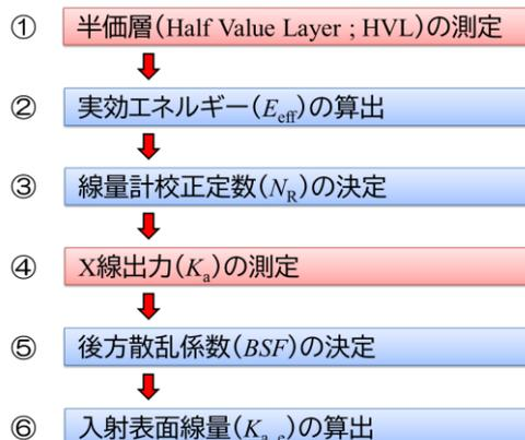
図1. 入射表面線量の算出手順。①と④は測定を行い、②、③、⑤、⑥は計算から導かれる。
