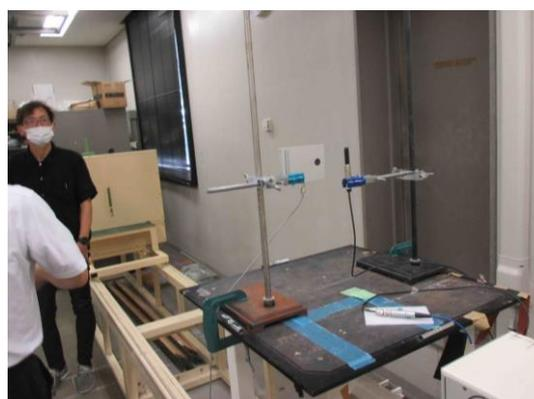
線量計の比較校正時の様子
