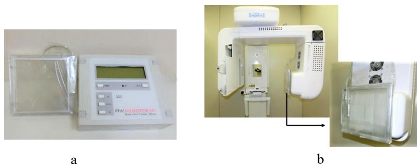
図2 Diamentor M4 (PTW) (a), 射出口側に貼り付けて測定 (b)
